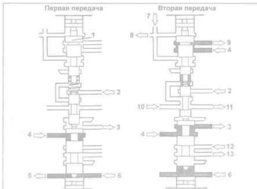
Клапан переключения 1-2. 1 - плунжер клапана обеспечения торможения двигателем на первой передаче, 2 - давление клапана-дросселя, 3 - к тормозу второй передачи (В 2 ), 4 - давление в основной магистрали, 5 - к понижающему клапану и клапану разрешения блокировки гидротрансформатора, 6 - давление скоростного регулятора, 7 - модулированное давление первой передачи, 8 - к основному регулятору давления, 9 - к тормозу первой передачи и передачи заднего хода, 10 - давление принудительно понижения передачи, 11 - к клапану переключения 2-3, 12 - модулированное давление второй передачи, 13 - к тормозу обеспечения торможения двигателем на второй передаче (В 2 ).
